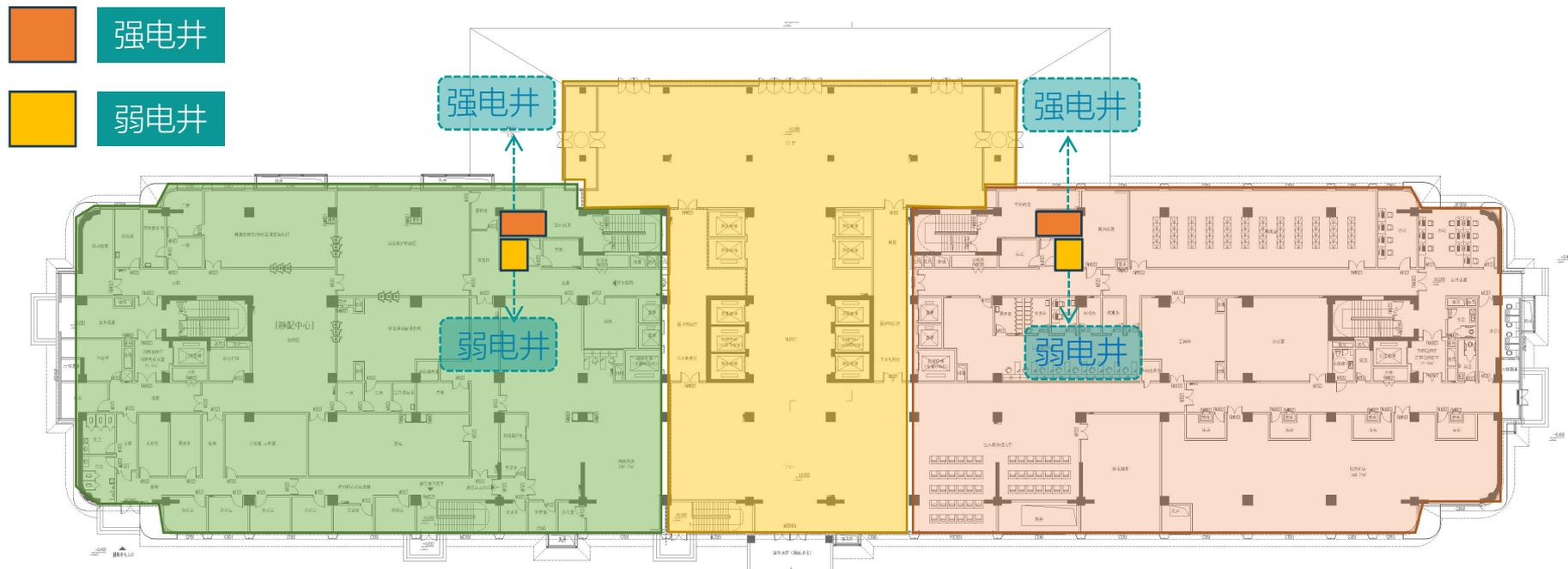
合理的机房及电井选址，使供电深入负荷中心，缩短供电半径，减少电能损耗。地下车库设置充电桩电表间。
